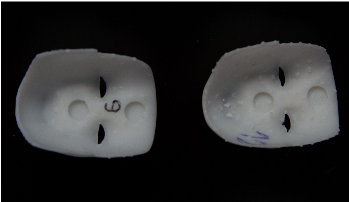
Slika 18: Površina modela prvega (levo) in drugega tiska (desno) po odstranjevanju podpornih struktur
