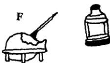
4. Se prepara el yeso, poniendo en una palangana unas cinco tasas de agua y sobre el agua se va vaciando el yeso de buena calidad poco a poco, sosteniéndolo en la palma de la mano, y dejándolo escurrir entre los dedos hasta que el yeso comience a sobresalir de la superficie del agua. (G) Se mezcla con la mano, deshaciendo los grumos y homogenizando la mezcla, hasta que tenga la consistencia de crema líquida.
