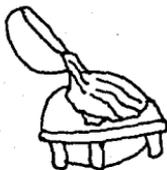
5. El yeso se chorrea sobre la cara comenzando por las facciones que tengan más detalle y terminando por dar una capa uniforme y progresiva de unos 2 cm. de espesor mínimo sobre los rasgos más prominentes. (H)
