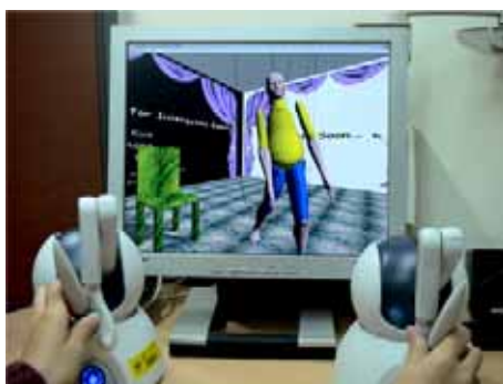
Fig. 23 – Utilização da interface Sensable's Omni para interagir com a aplicação [54].
